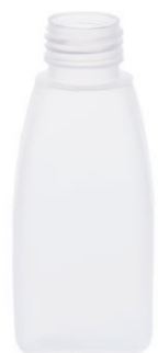
商品コード10147714 PPF150角 サイズ: 48角×112h 口径: 28φ 容量: 170ml 材質: PP 入り数: 702 重量: 15.0g
